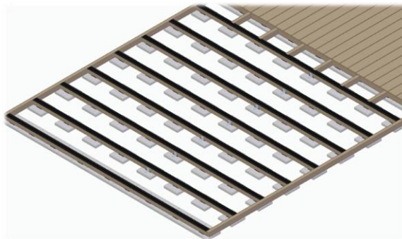
Bjälklagstejp mellan altanbrädor och reglar
